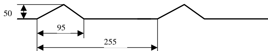
图 6 振动干扰测试路面条件要求示意图
